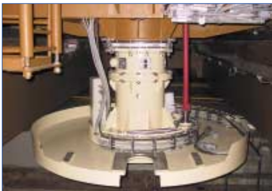
Монтаж на въртяща се платформа на телевизионна камера на презареждащата машина
